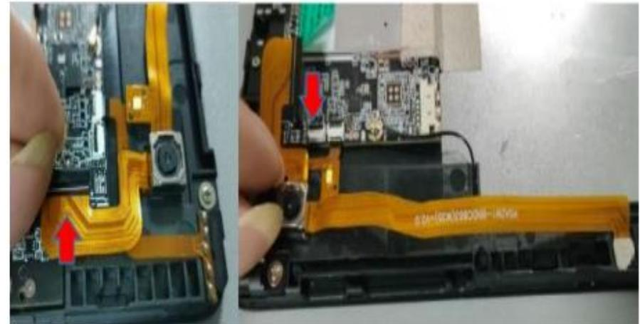
Step 7: Remove 1PCS screw from the headphone jack, detach the headphone jack assembly, release the antenna clip then remove the antenna/ÉTAPE 7 : Retirer la vis de la prise casque, détacher l'ensemble de la prise casque, déverrouiller le clip de l'antenne, puis retirer l'antenne
