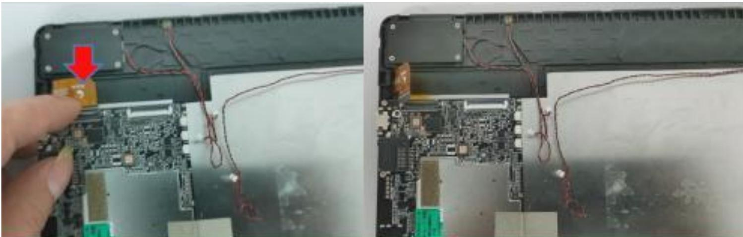
**STEP FIVE: Remove 8 PCS speaker screws and remove the left/right speakers and MIC / ÉTAPE 5 : Retirer les 8 vis des haut-parleurs, puis retirer les haut-parleurs gauche/droite ainsi que le microphone.**
