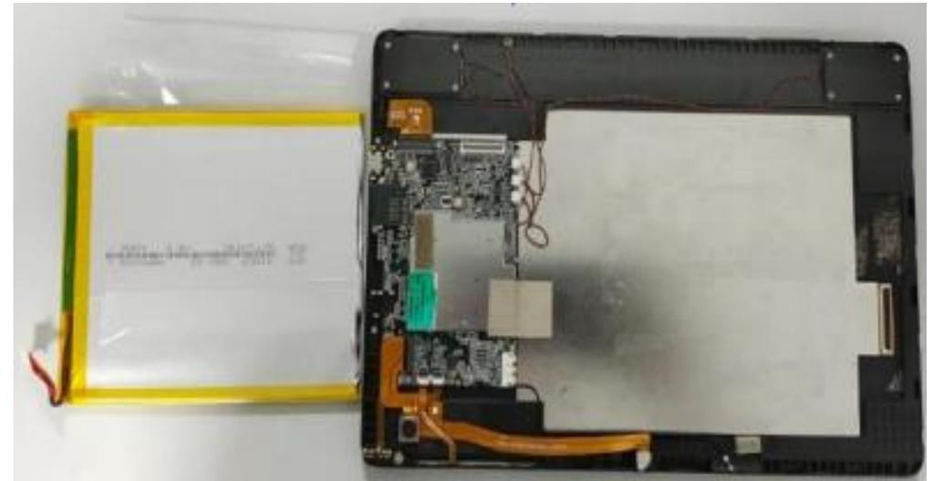
STEP FOUR: Disconnect the left/right speaker and MIC connectors, and remove the Touch Panel FPC cable / Déconnecter les connecteurs des haut-parleurs gauche/droite et du microphone, puis retirer le câble FPC du panneau tactile
