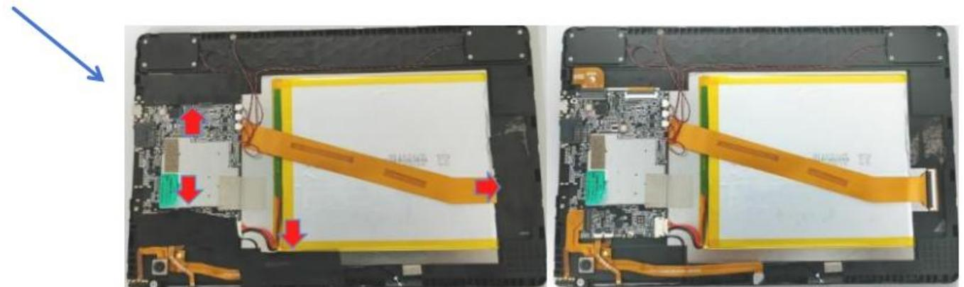
STEP THREE: Disconnect the battery cable and LCD FPC cable, pull the battery adhesive tabs to remove the battery/ ÉTAPE 3 : Déconnecter le câble de la batterie et le câble FPC de l'écran LCD, puis tirer sur les languettes adhésives de la batterie pour la retirer
